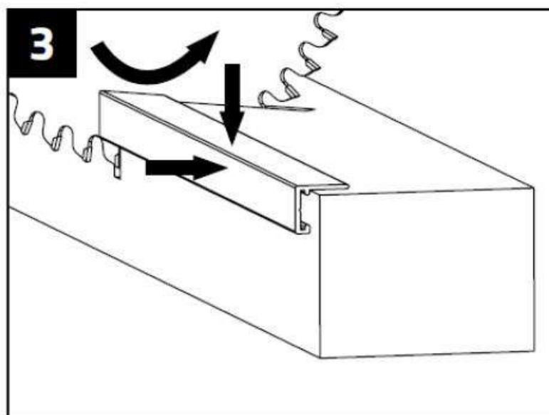
4. Монтажные зажимы вставляются в торцевую планку спереди. Внимание: в торцевую планку встроены два противоположных выступа, между которыми можно легко перемещать монтажные зажимы.
