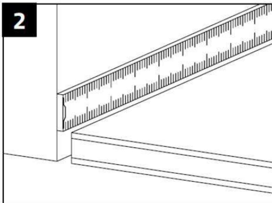
3. Профили нарезаются по размеру. Срез под углом для внутреннего или внешнего угла выполняется за одну операцию. Профиль надежно прижимается к деревянной опоре и правильно позиционируется в пиле. Направление резания пилы прижимает профиль к деревянной опоре во время резки.
